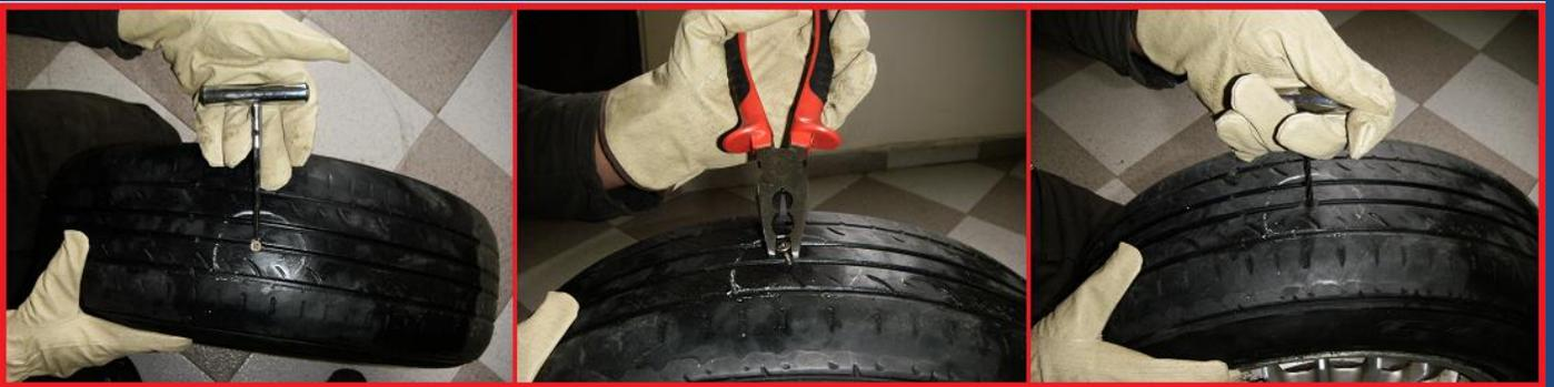
Retire el taco mecha del empaque, y páselo por el ojo de la aguja de aplicación, hasta que quede en la mitad, aplique solución vulcanizante y deje secar por 3 minutos.
