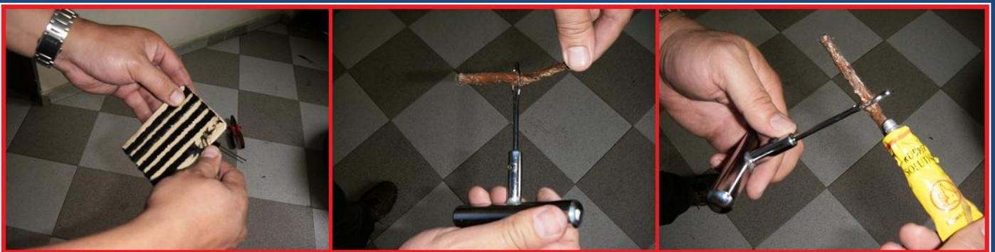
Retire rápidamente el punzón que esta incrustado en el lugar del daño, e inmediatamente inserte la aguja de aplicación hasta la mitad del taco mecha de forma tal que quede la mitad en el interior y la otra en el exterior, gire la aguja de aplicación en sentido de las manecillas del reloj 90° luego retire rápidamente.
